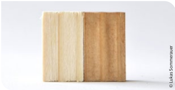
Bild 2: Fichtenproben im Vergleich. Links unbehandelt, rechts mit Lärchenextrakt imprägniert. Es kommt zu einer farblichen Veränderung der Textur, die auf die eingebrachten Extrakte zurückzuführen ist.
