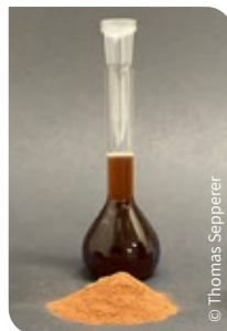
Von Rohmaterial zum Extrakt – die Rindenbiomasse wird mit Wasser extrahiert und löst die bioaktiven Substanzen der Rinde. Später werden diese mittels Druck dann in Fichten- oder Tannenholz imprägniert.
