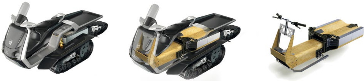
Abb. 2: Holz-Chassis eines elektrisch betriebenen Raupenfahrzeugs „Ardenner“ (Foto: MATTRO, Quelle: WoodC.A.R.). Bei gleicher Performance konnte gegenüber dem Prototyp in Stahl 140 kg Gewicht eingespart werden.
